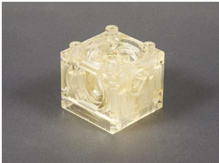
Rys. 1 Rzeczywisty model uzyskany metodą „szybkiego prototypowania”
