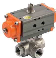
Valvola a sfera a 2 e 3 vie, microfusa sabbata, in acciaio inox AISI 316.
